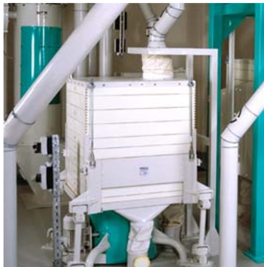
Fig. 25: MPAR Plansifter pequeño Rotostar
