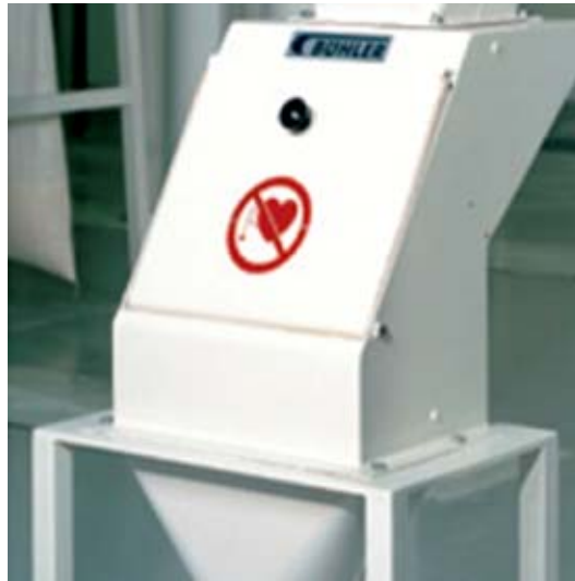
Fig. 21: MMUA Separador magnético
