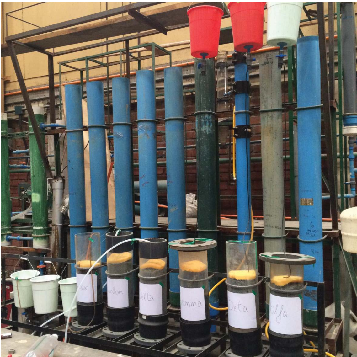
Imagen 4. Columnas montadas para pruebas de lixiviación a condiciones de 1 atm y 25 [°C]
