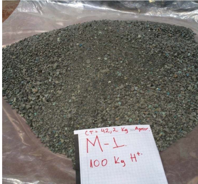
Imagen 7. Muestra de polvo convertidor Teniente sin aglomerar, día 0
