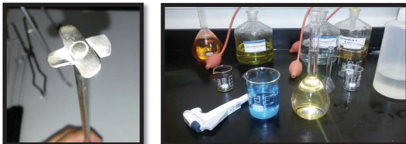
Figura 6.4: Aspas (imagen izquierda); soluciones de electrolito sintético y CPM TM 3406 10% v/v (imagen derecha).
