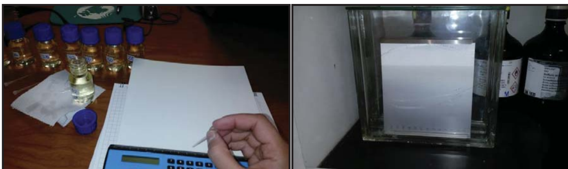
Figura 6.7: Sembrado de muestras en placa sílica gel y cubeta con solventes n-hexano y tolueno.
