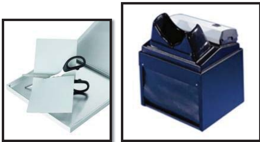
Figura 5.2: Placa de Sílica gel y cámara oscura con luz ultravioleta.
