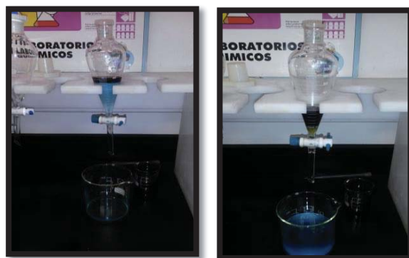
Figura 6.10: Imagen izquierda: Embudo de decantación con solución acuosa y solución orgánica; Imagen derecha: Embudo de decantación con orgánico cargado y refino descartado
