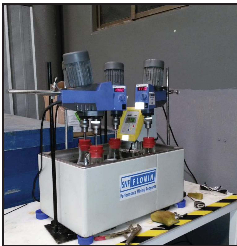
Figura 6.1: Montaje Experiencia Degradación Acelerada (A, B, C y D)
