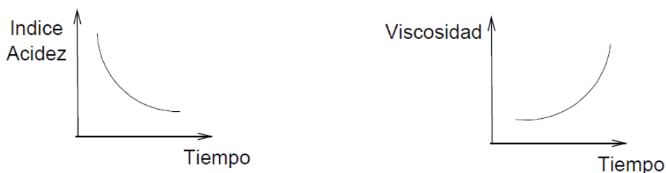
Ilustración 34: Fluctuación de parámetros (índice de acidez y viscosidad) en función del tiempo de reacción. (Development, Advanced Chemistry, 2008)
