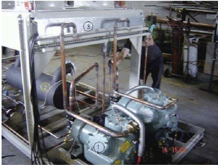
Fig. 1.4 Esquema de un Chiller
