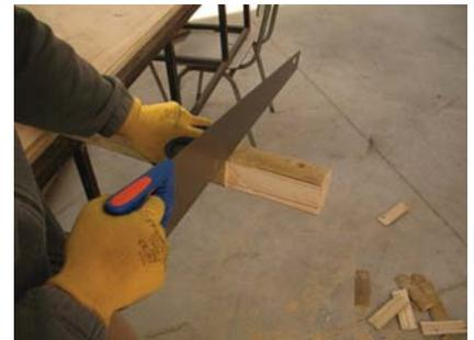
Los rollizos se internievan aserrando los extremos y generando en ellos una sección cuadrada que se inscribe dentro del diámetro del tubo, de esta forma, los vértices resultan desmontables.
