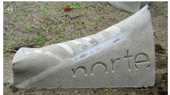
37 al 41.- Recopilación de proyectos relacionados con el proyecto. 42.- Prototipo Final, 43.- Pruebas de señas en moldaje flexible, 44.- Detalle de una prueba de moldaje flexible.
