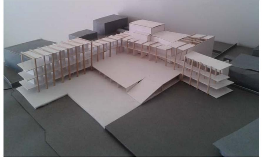
*Estructuración Proyecto por Muros y pilares (Marcos rígidos)*
