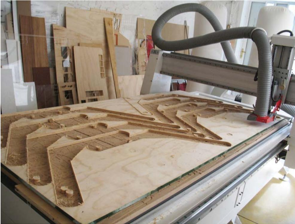
Conformación de la pieza 1, donde se logra apreciar la cubicación de la pieza en el material, y la precisión en que trabaja la máquina. La plancha es fijada en la mesa de trabajo en 6 puntos atornillados, y en el proceso de cortado se va definiendo que puntos tienen que ser reforzados para que no interfieran en el proceso. Las piezas a medida que son cortadas son retiradas de la plancha.
