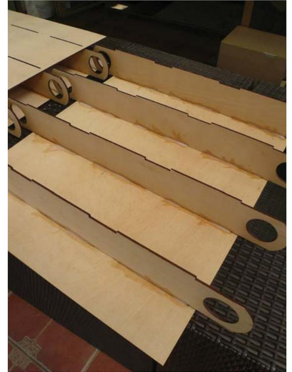
Tras ser cortadas en la láser, las piezas pasan por un segundo proceso que es el encolamiento de éstas, para la conformación de la pieza 3, constituida por dos caras de terciado de 3, unidas por 4 costillas transversales a éstas.
