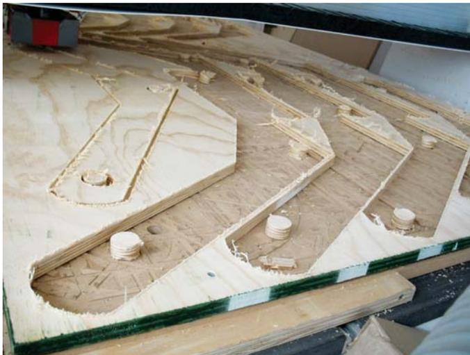
Proceso de cortado, realizado en la máquina router CNC
