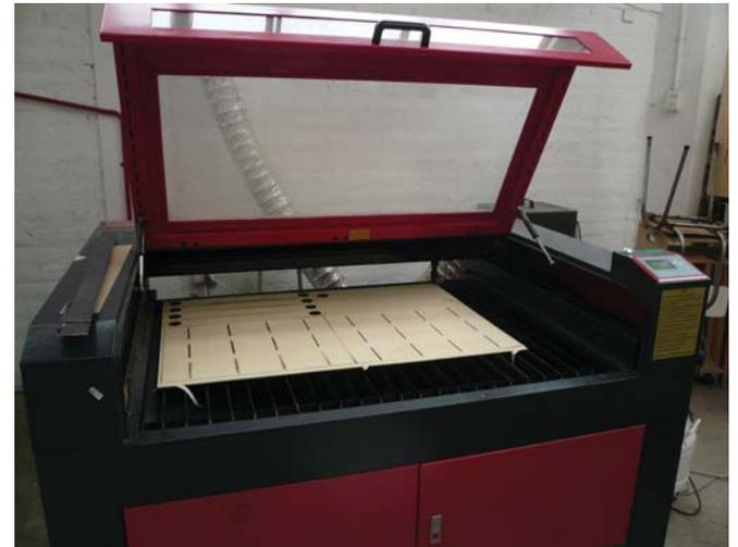
Cada plancha de terciado se divide en dos partes de 102x150 cm y ésta se pone en dos partes en la láser, ya que la superficie de trabajo de ésta es de 90 x 120 cm. en un primer momento se corta la primera mitad y luego , tras girar la sección se corta la segunda parte, como muestra el esquema de la derecha.
