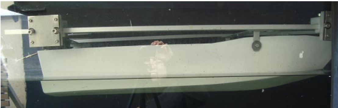
Figura 143.- Igualación de la línea de flotación con los elementos para las pruebas. Fuente: Propia.
