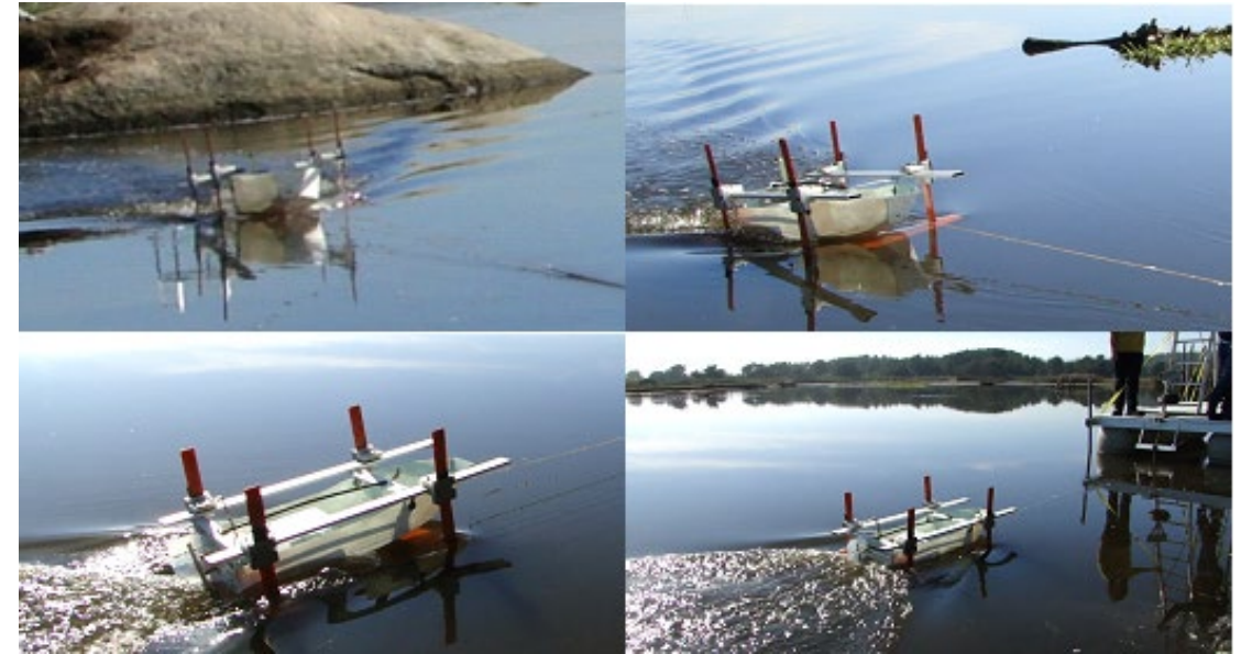
Figura 153- Secuencia de arrastre prueba 4. Fallida basura en los perfiles alares. Fuente: Propia.
