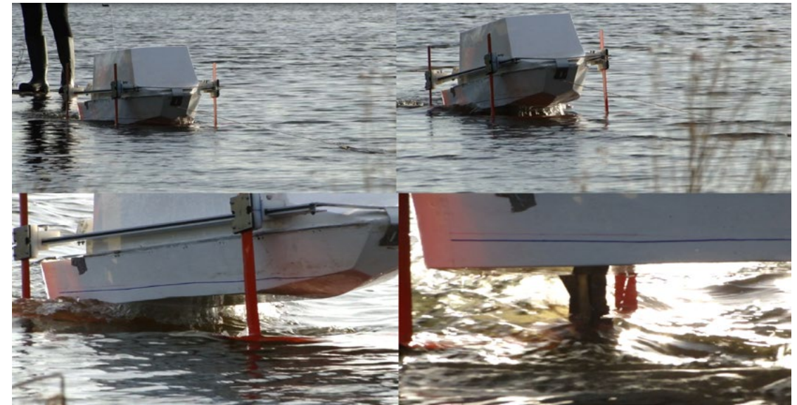
Figura 195.- Secuencia de arrastre prueba 4. Levantó en proa a los 5 segundos, levantó completamente popa a los 12 segundos se inclinó a babor. Fuente: propia.
