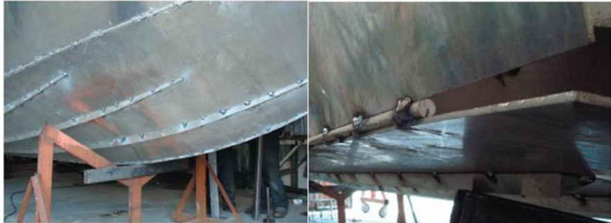
Figura 89.- Construcción de forro a través de planchas de aluminio. Fuente: Egidio Jeria Presentación “Visita Sitecna”.
