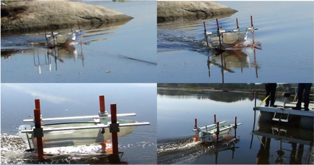
Figura 154. -Secuencia de arrastre prueba 5. Exitosa inicia vuelo correcto a los 9 Segundos. Fuente: Propia.
