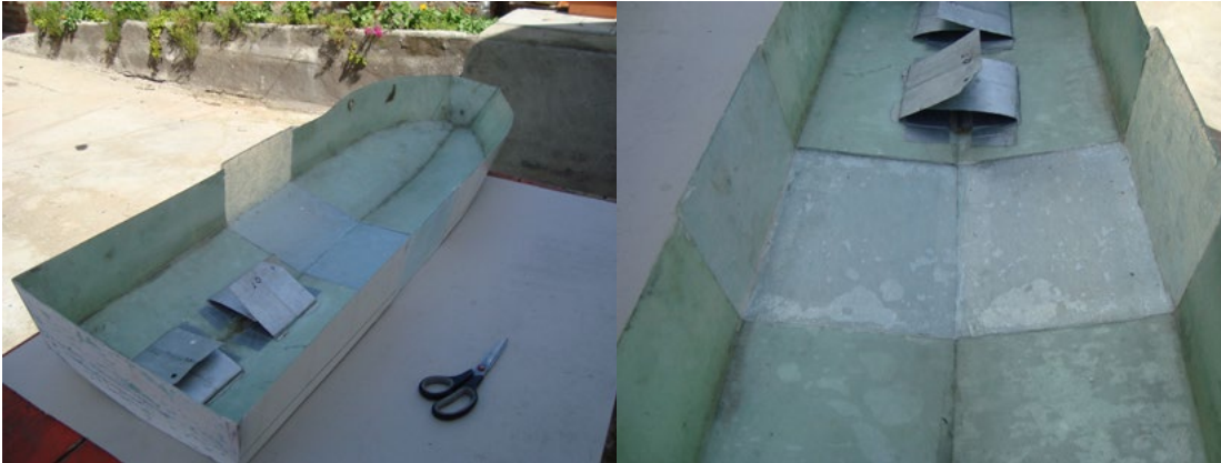
Figura 178.- Intervención del modelo de pruebas 1, extensión en su eslora. Fuente: Propia.
