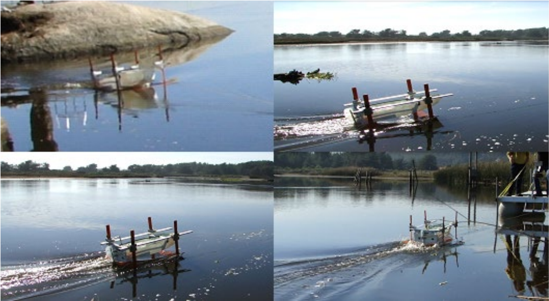
Figura 151.- Secuencia de arrastre prueba 2.Exitosa inicia vuelo con dificultad a los 10 segundos. Fuente: Propia.
