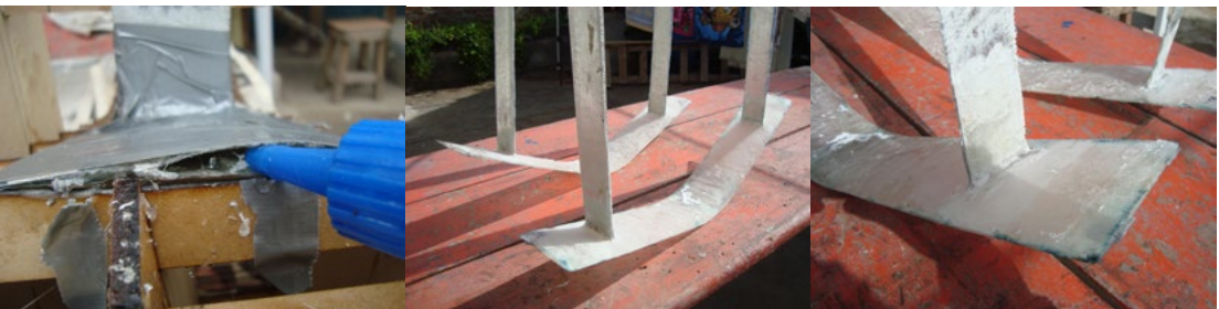
Figura 6.- a) Llenado de los perfiles con resina. b) y c) Perfiles desmoldados. Fuente: Propia.
