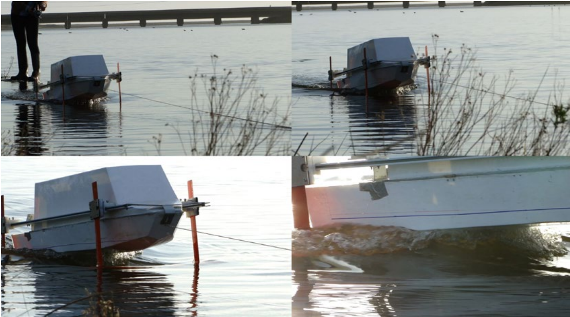
Figura 196.- Secuencia de arrastre prueba 5. Levantó en proa a los 6 segundos, arrastre en popa hasta llegar a destino. Fuente: propia.
