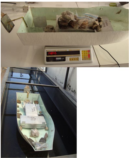
Figura 140.- Ubicación de todos los pesos para demostración de estabilidad. Fuente: Propia.
