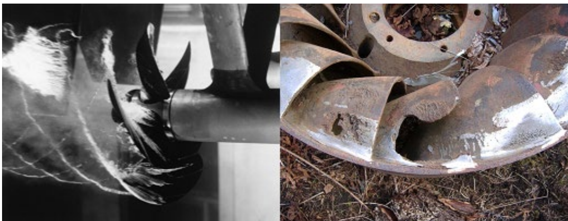
Figura 102.- Cavitación en una hélice y el daño causado en una turbina. Fuente: Wikipedia.
