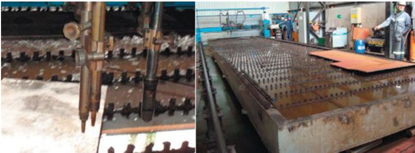
Figura 88.- Corte de planchas de Aluminio con plasma. Fuente: Egidio Jeria Presentación “Visita Sitecna”
