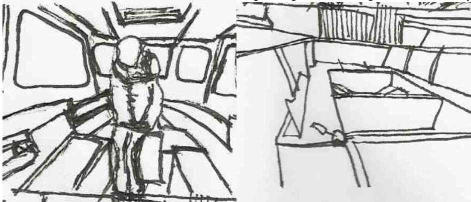
Figura 45 .- Polifuncionalidad de los asientos, espacio para guardado en su interior. Fuente: Elaboración propia.
