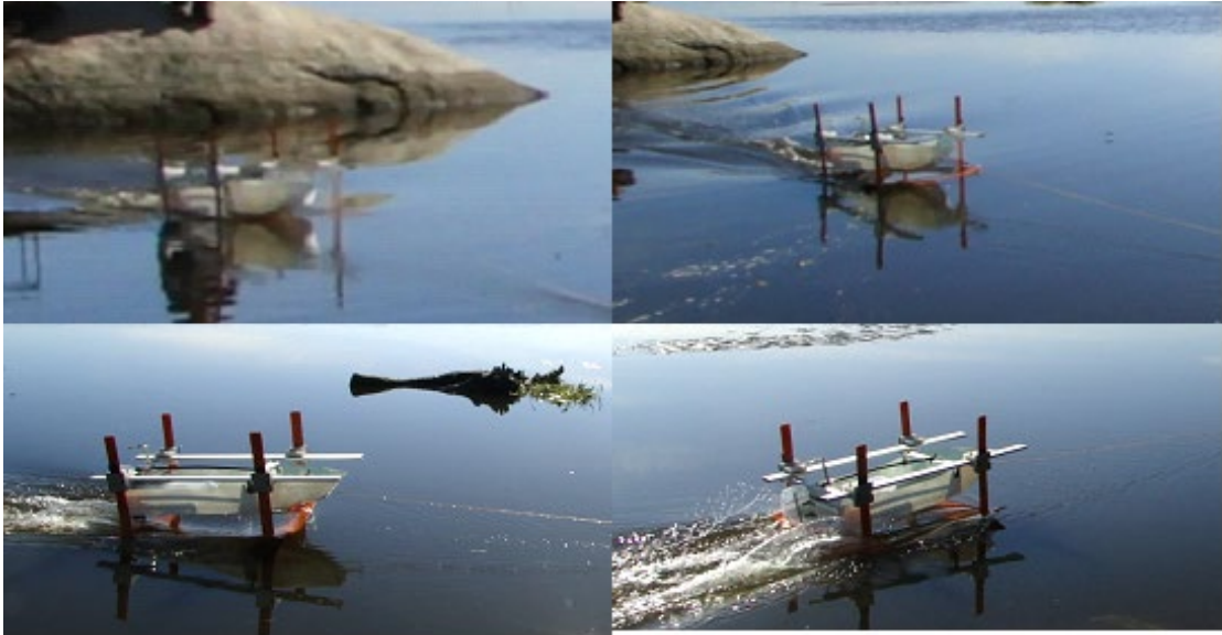
Figura 155.- Secuencia de arrastre prueba 6. Exitosa inicia vuelo correcto a los 2 segundos. Fuente: Propia.
