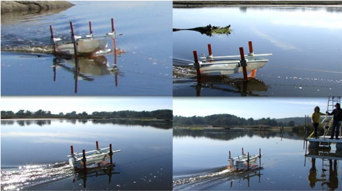
Figura 152. -Secuencia de arrastre prueba 3. Exitosa inicia vuelo con dificultad a los 12 segundos. Fuente: Propia.
