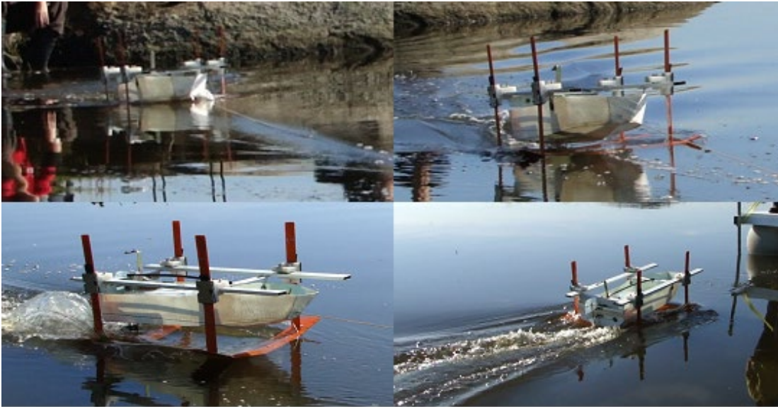
Figura 156.- Secuencia de arrastre prueba 7. Exitosa inicia vuelo correcto a los 8 Segundos. Fuente: Propia.
