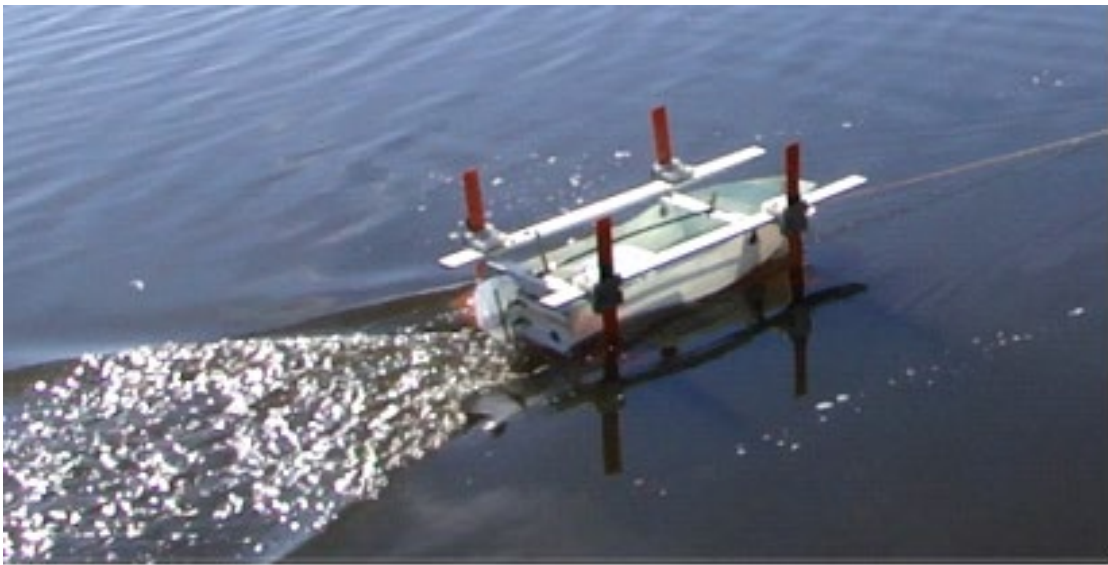
Figura 159.- Prueba 10. Fallida no levantó por roce en el fondo debido bajo nivel de agua en el estero. Fuente: Propia.
