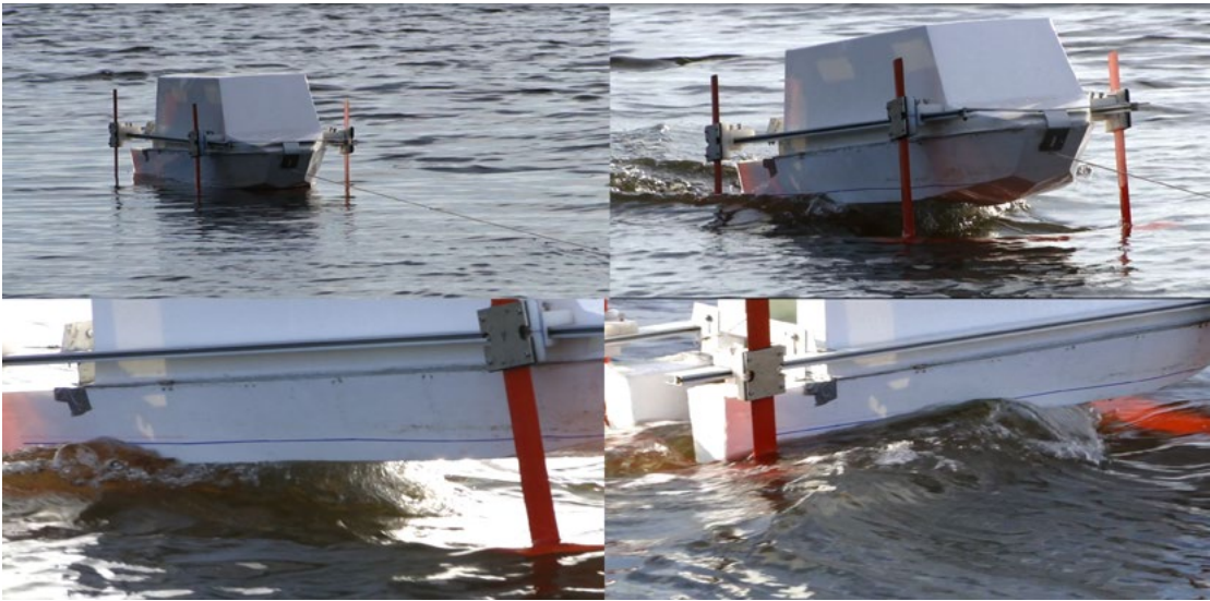
Figura 192.- Secuencia de arrastre prueba 1. Levantó en proa a los 5 segundos, arrastre en popa hasta llegar a destino. Fuente: propia.
