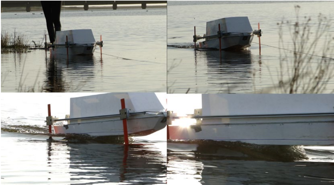
Figura 197.- Secuencia de arrastre prueba 6. Levantó en proa a los 7 segundos, arrastre en popa hasta llegar a destino. Fuente: propia.
