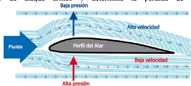
Figura 96.- Comportamiento de un perfil alar ante un fluido. Fuente: Elaboración propia.
