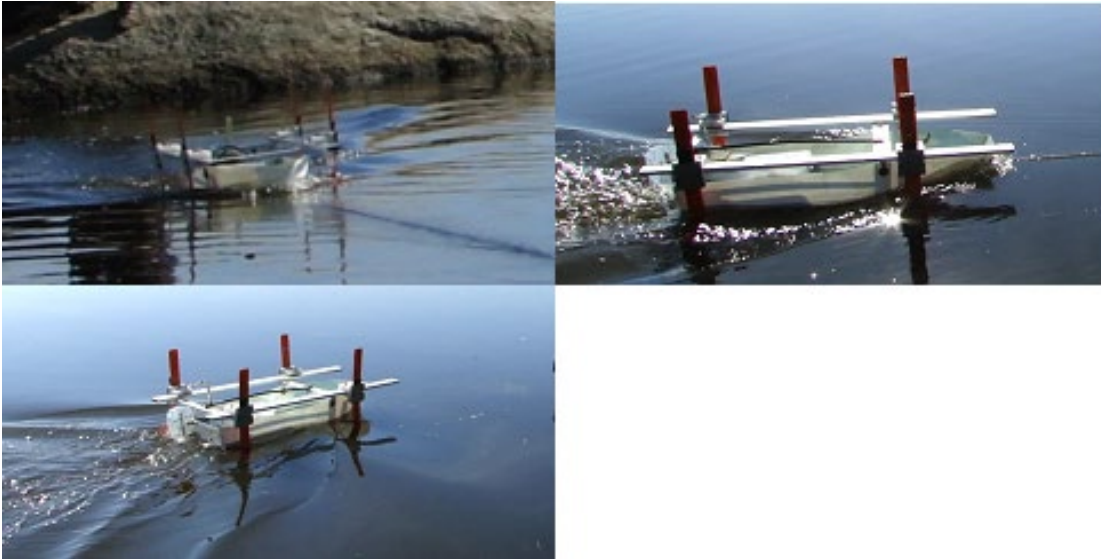
Figura 158. -Prueba 9. Fallida no levantó con el peso de 4 pasajeros a escala. Fuente: Propia.
