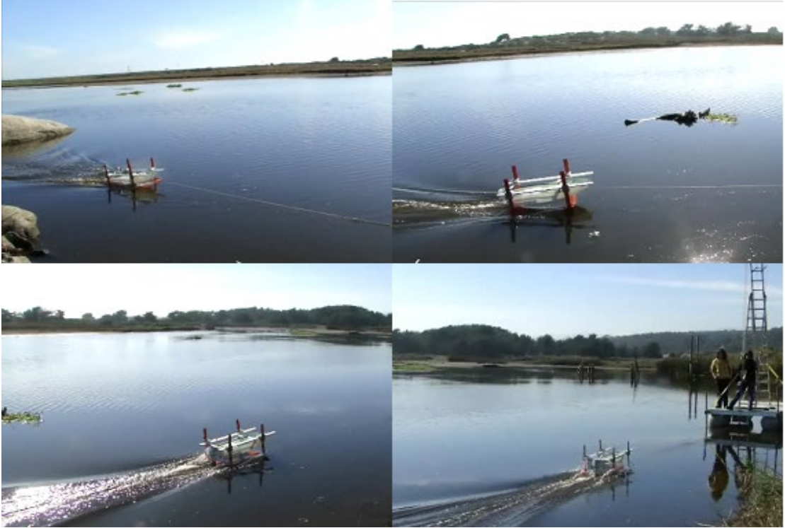
Imagen 150.- Secuencia de arrastre prueba 1. Exitosa inicia vuelo a los 5 Segundos. Fuente: Propia.
