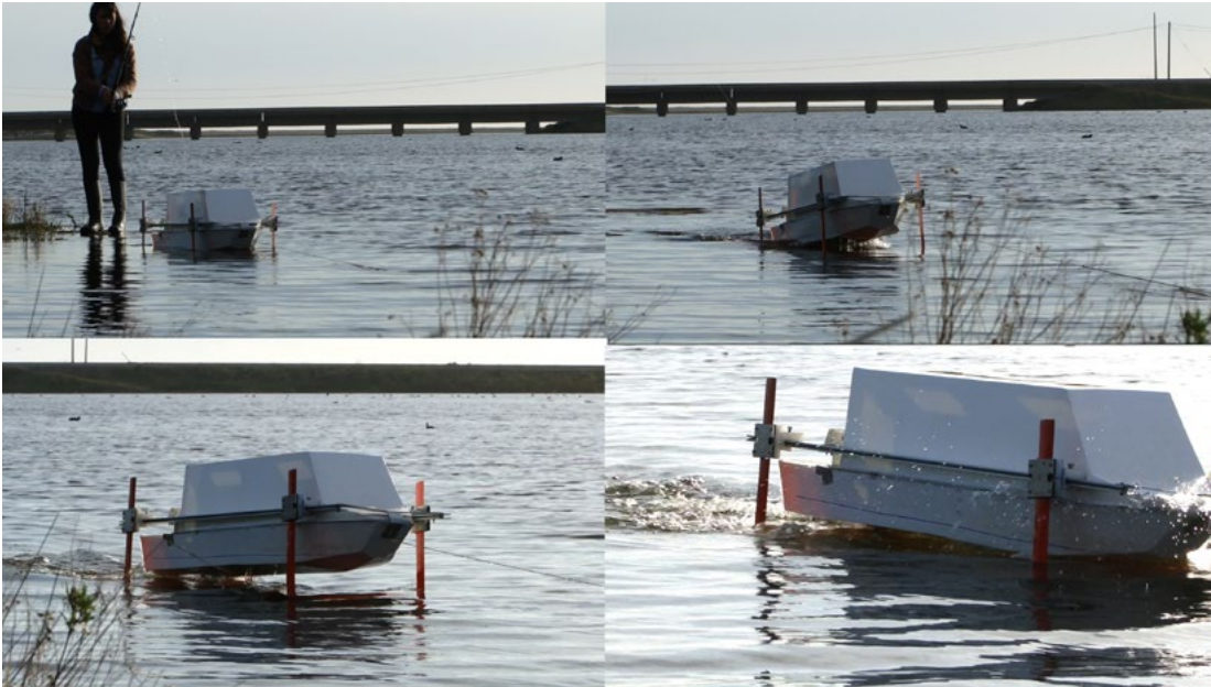
Figura 194.- Secuencia de arrastre prueba 3. Levantó en proa a los 5 segundos, levantó completamente popa a los 8 segundos se escoró y bajó bruscamente a los 10 segundos de iniciado el arrastre. Fuente: propia.
