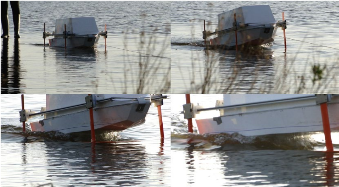
Figura 198.- Secuencia de arrastre prueba 7. Levantó en proa a los 5 segundos, levantó la popa completamente a los 16 segundos y se escoró a babor antes de llegar a destino. Fuente: propia.
