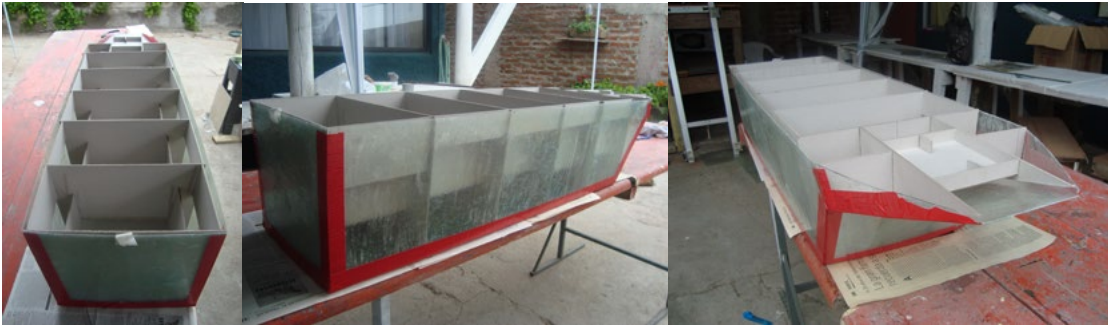
Figura 1.- Superestructura en fibra de vidrio. Fuente: Propia.
