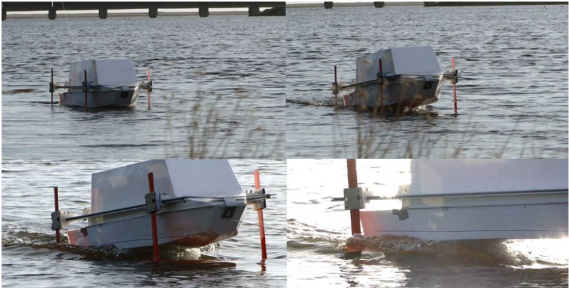
Figura 193.- Secuencia de arrastre prueba 2. Levantó en proa a los 7 segundos, levanto completamente popa a los 16 segundos. Fuente: propia.
