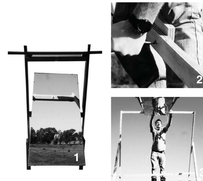
Fig 1: Como queda el espejo instalado para calibrarlo se indica al horizonte
