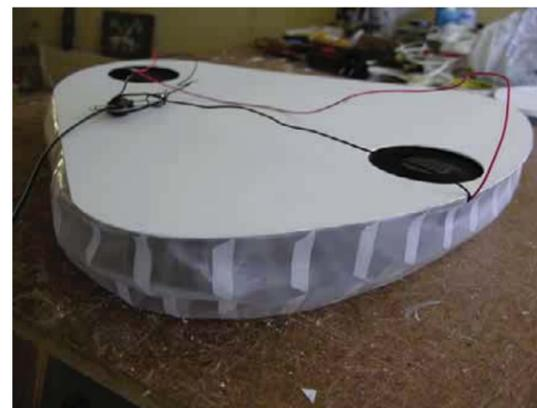
polietileno perforado, permite la salida del aire hacia la cavidad para formar el colchón y generar suspensión
