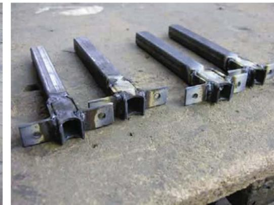
horquillas que fijan las ruedas a la estructura
