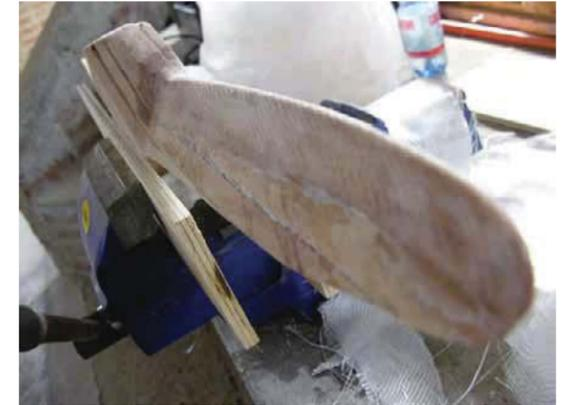
pulido de la fibra para lograr una superficie lisa en función al paso del viento.
