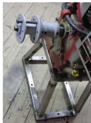
acople en eje del motor
