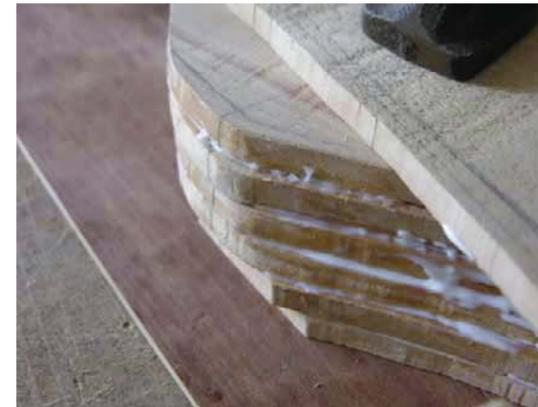
detalle encolado, construcción del laminado
