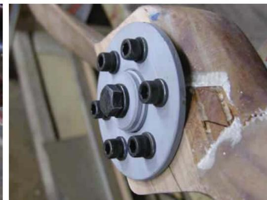
detalle sujeción hélice a acople
