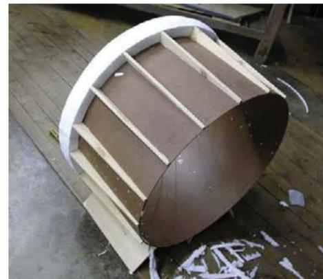
ensamblado del anillo en estructura principal, tobera
