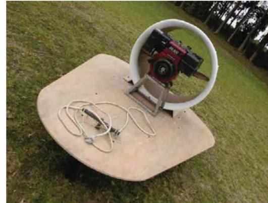
prototipo final para prueba de turbina
