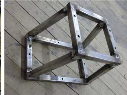
estructura terminada, se perfora para ser apernada a la superficie principal y para anclar el motor a ella
