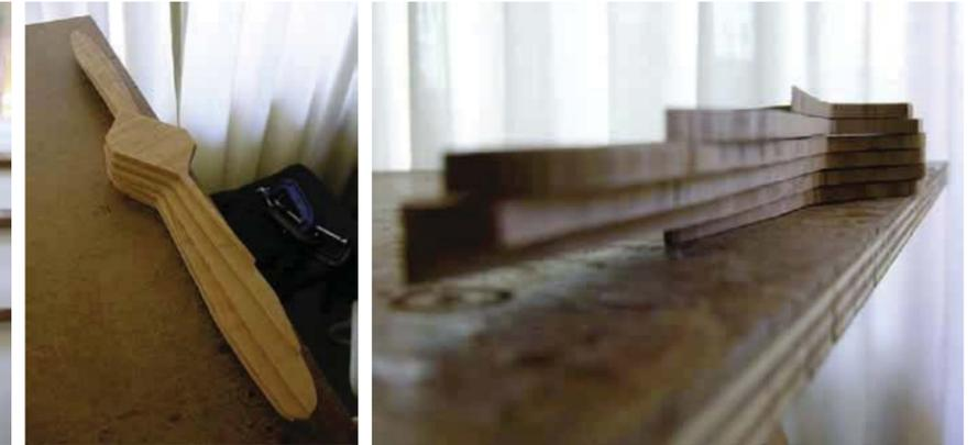
disposición de laminas que construyen la hélice, listas para ser prensadas
