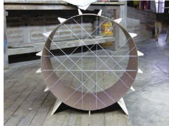
cilindro de cholguan estructurado con tensores de alambre
