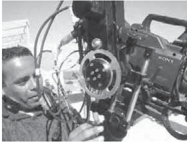
Sistema para equilibrar el centro de gravedad de la cámara
