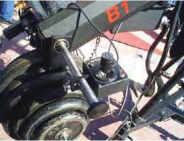
Sistema para equilibrar el centro de gravedad de la cámara
