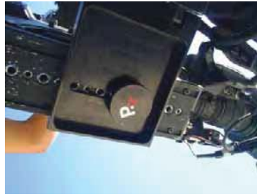
Sistema para equilibrar el centro de gravedad de la cámara
