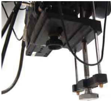
Cabezal ajustable con motores de alto torque y baja revolucion
