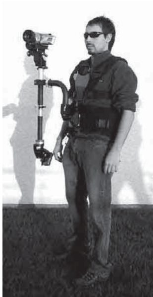
El brazo soporta y amortigua la carga
