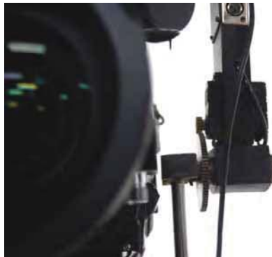
Cabezal ajustable con motores de alto torque y baja revolucion
